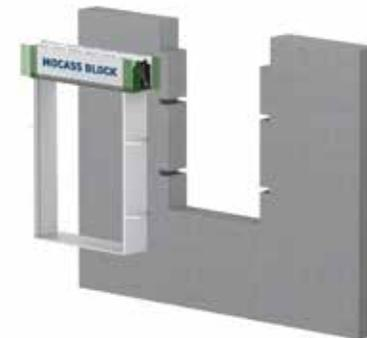
Il rilievo delle misure va effettuato con la massima attenzione. Consigliamo una tolleranza minima di 20 mm per lato.
