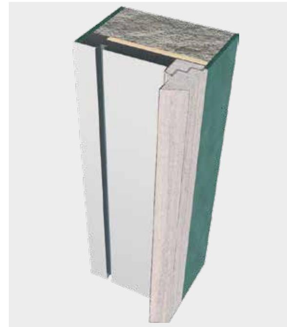
I controtelai proposti dalla Mocass sono gli elementi di connessione tra la muratura e l'infisso. Tramite la loro posa, il montaggio dell'infisso sarà più facile, veloce e preciso. Sono realizzati su misura ed in base alle esigenze del cliente. La parte in legno può essere in OSB3 oppure in multistrato fenolico (con spessore 18 mm per telaio legno/lamiera oppure
