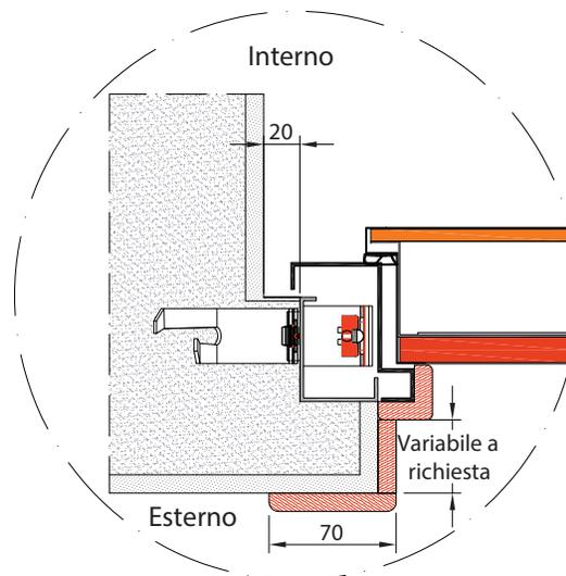
Montaggio con telaio in luce con cornici in legno
