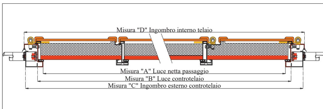
Sezione telaio e controtelaio
