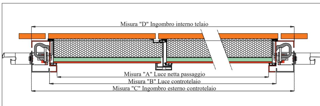
Sezione telaio e controtelaio
