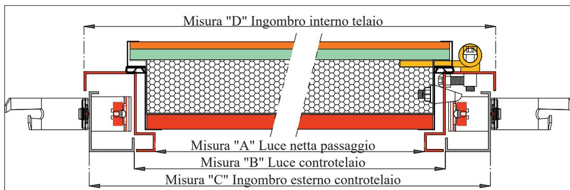
Sezione telaio e controtelaio
