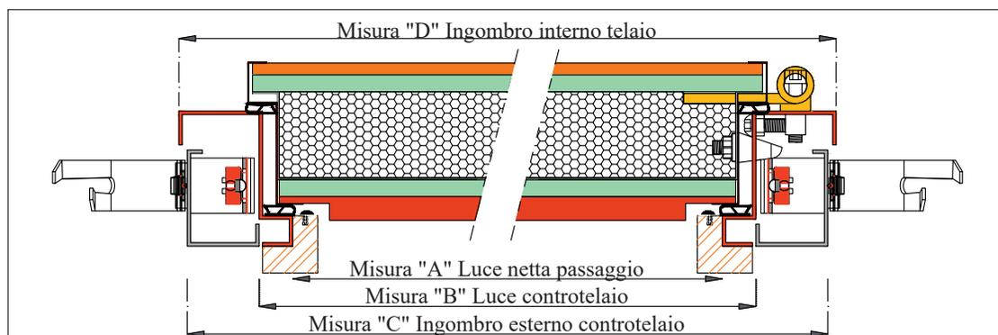
**Sezione telaio e controtelaio**
