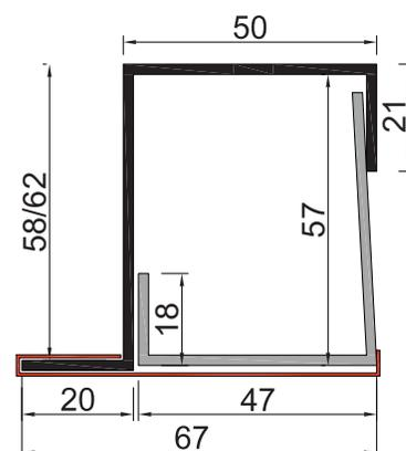
Controtelaio e telaio ridotto monoblocco
