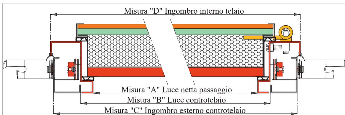
Sezione telaio e controtelaio
