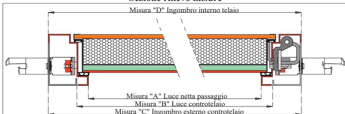
**Sezione telaio e controtelaio**
