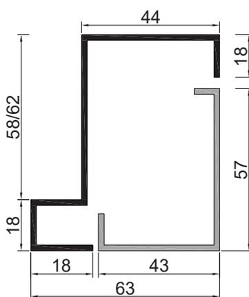
Telaio a filo controtelaio
