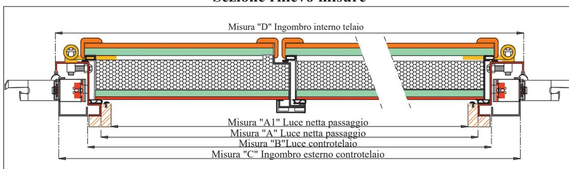
Sezione telaio e controtelaio
