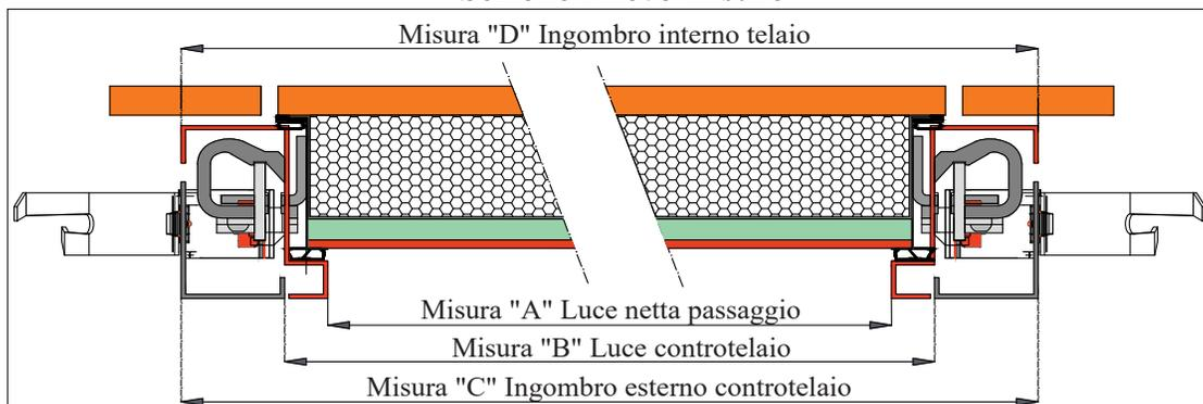
Sezione telaio e controtelaio
