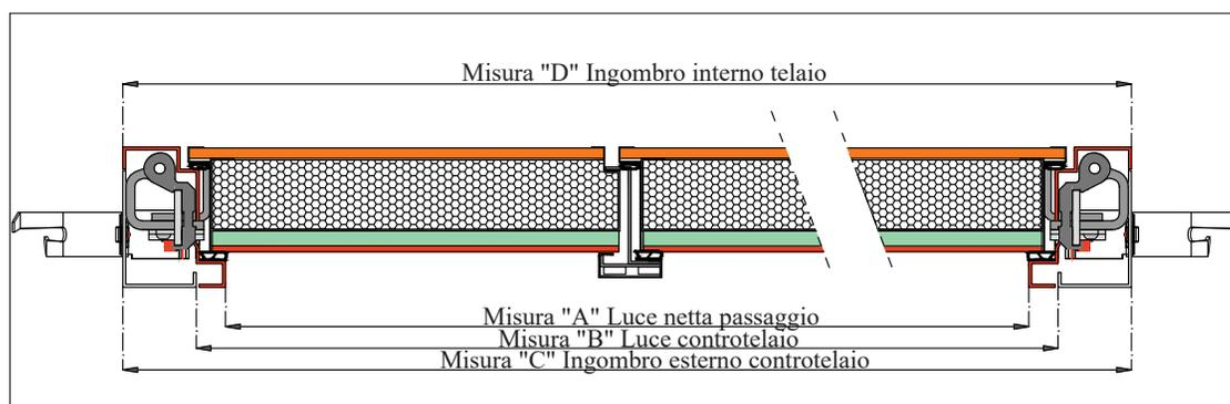
Sezione telaio e controtelaio
