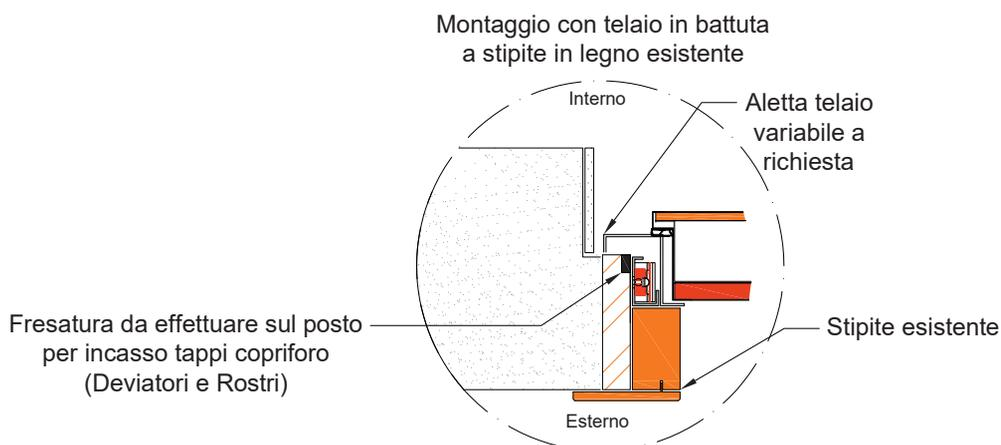
Il controltelaio CT3 Slim e CT3 Micro possono essere installati solo mediante turboviti, barre filettate con ancoraggio chimico, fisher adeguati
