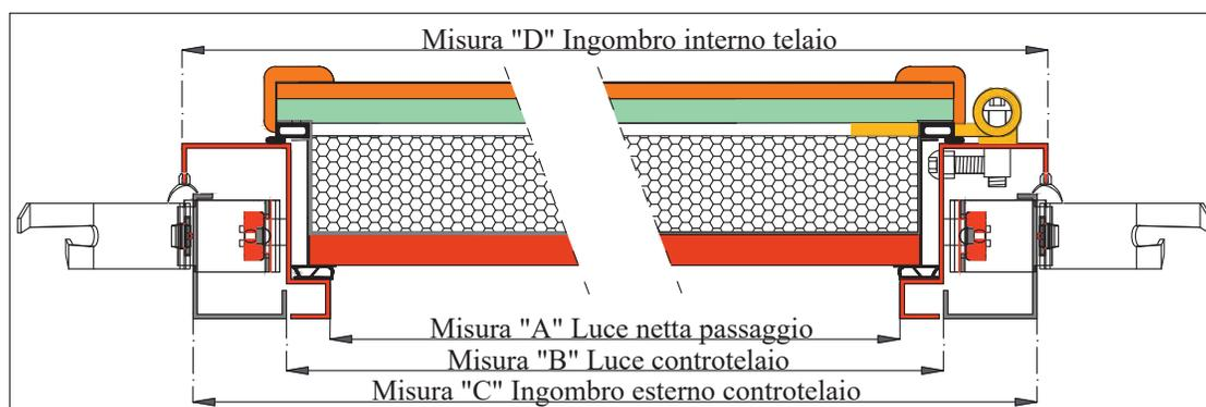
Sezione telaio e controtelaio
