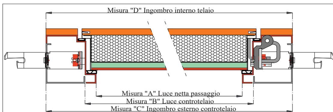
Sezione telaio e controtelaio
