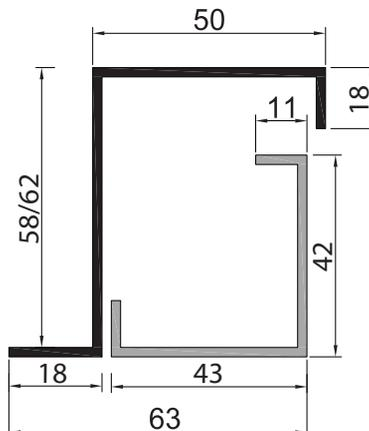
Controtelaio e telaio ridotto
