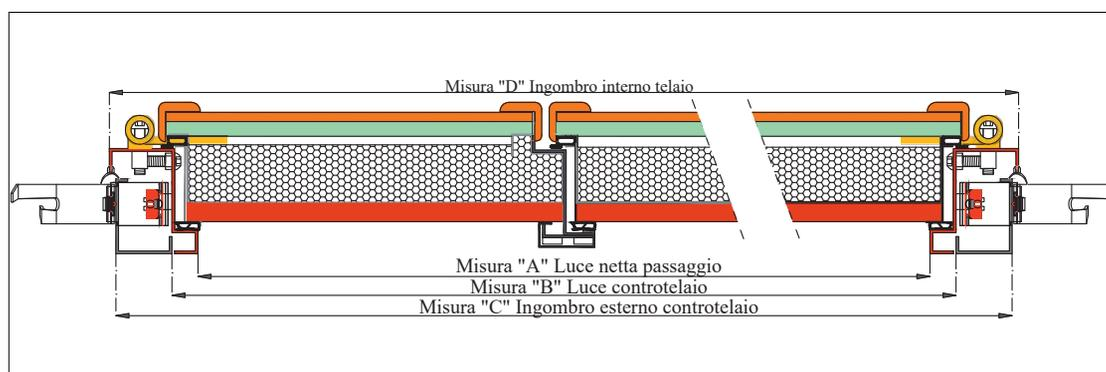
Sezione telaio e controtelaio
