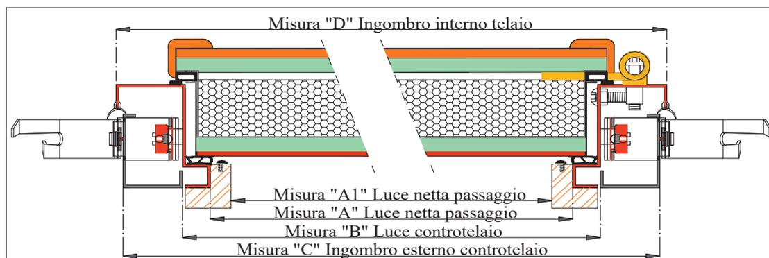
Sezione telaio e controtelaio
