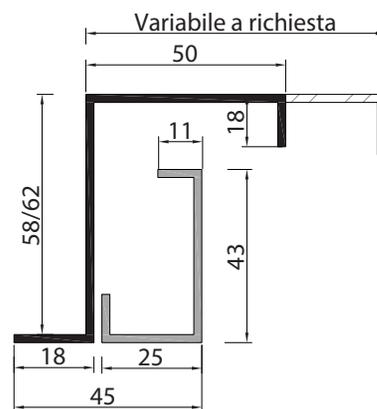
Telaio e controtelaio per applicazioni su telai in legno non removibili
