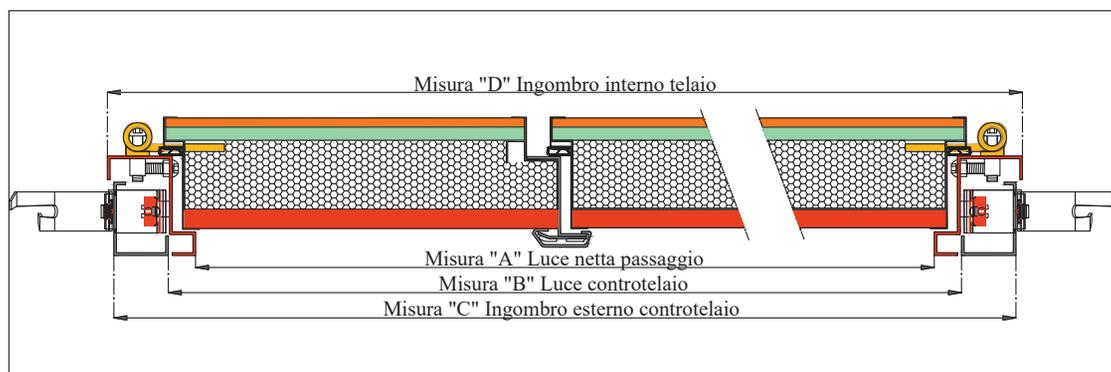
Sezione telaio e controtelaio
