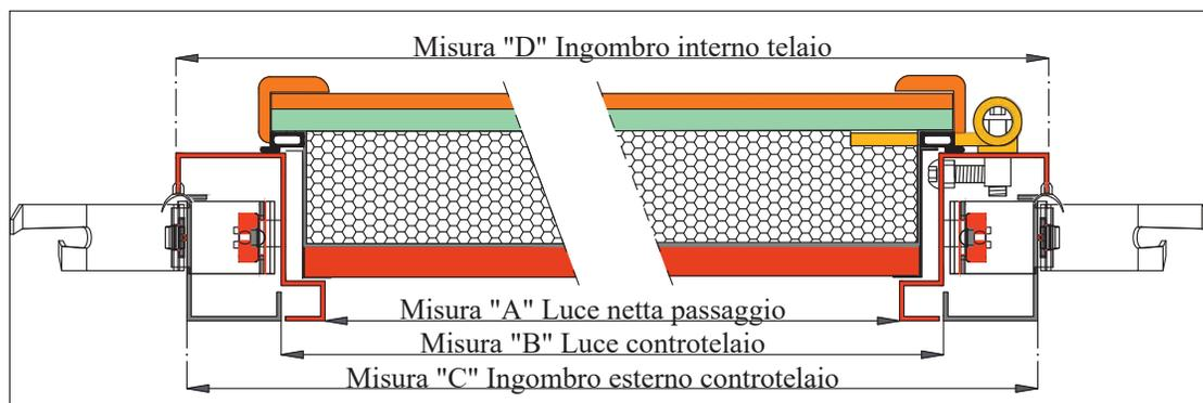
Sezione telaio e controtelaio
