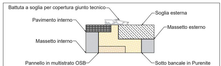
**Attenzione:** La cornice perimetrale in legno per l'isolamento termico del telaio occupa uno spazio pari a 15 mm per lato (30 mm totali) e 15 mm in altezza, pertanto la luce netta passaggio su una porta da mm 900x2100 si riduce a mm 870x2085
