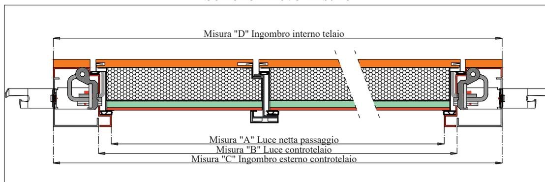
Sezione telaio e controtelaio
