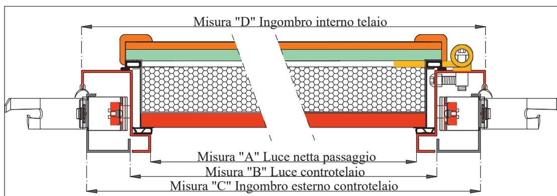
Sezione telaio e controtelaio
