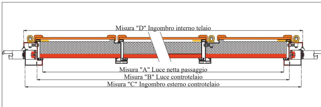
Sezione telaio e controtelaio
