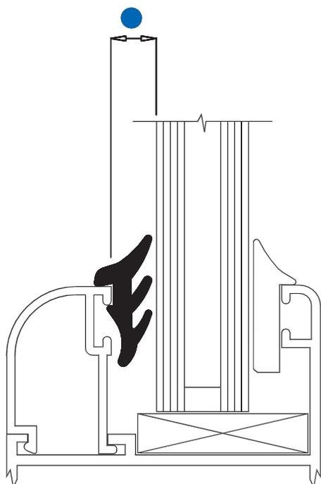
Le nostre guarnizioni fermavetro **UP** sono studiate per essere impiegate sui principali sistemi di profili. La loro particolare geometria agevola la messa in opera.
