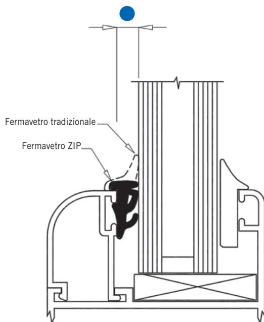
Le nostre guarnizioni fermavetro interne universali **ZIP** si distinguono da quelle tradizionali per la loro geometria studiata per ridurre al minimo l'impatto visivo. Ideale per velocizzare il lavoro dell'installatore perché progettata per seguire tutto il contorno della cornice senza la necessità di essere tagliata negli angoli.
