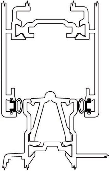
Finalmente una guarnizione al posto dello spazzolino! I vantaggi di una guarnizione in TPE che non si sporca ed isola dagli agenti atmosferici e dal rumore, uniti alla scorrevolezza di uno spazzolino. Realizzate per costruzione di uno strato sottile, in uno speciale materiale antiusura ed antiattrito, sulla superficie di scorrimento.
