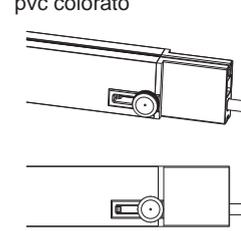
Sistema di bloccaggio del terminale con spinotto in acciaio Inox e gancio interno alla guida.
