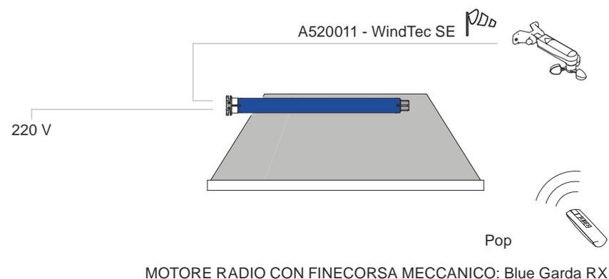
**1 B ESEMPIO IMPIANTO:** Tenda singola, motore a radio integrata, protezione vento e automatismo luce via radio; comando singolo a pulsante via cavo e radio.
