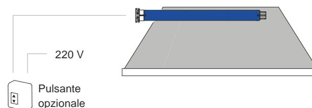
MOTORE CON FINECORSA MECCANICO: Blue Garda, Blue Ocean
