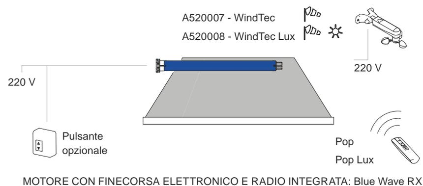
**2 B ESEMPIO IMPIANTO:** Due o più tende, motori a radio integrata, protezione vento e automatismo luce via radio; comando singolo a pulsante via cavo e comando singolo/generale con radio.
